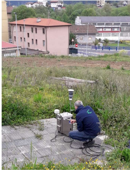
Instalando equipo de medición de partículas PM10.
